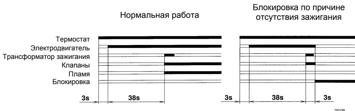
В случае погасания пламени во время работы горелки подача газа блокируется в течение 1 секунды.
